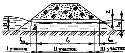
Рис. Е.1. Схема протекания воды в безнапорной МГТ, затопленной с нижнего бьефа с незатопленным свободным сечением
